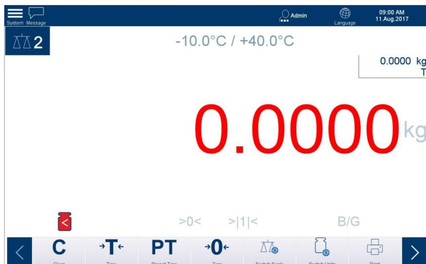
Figura 2-32: MinWeigh activado, peso por debajo del umbral
