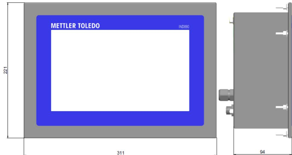
Figura 1-2: Dimensiones de IND930, montaje en la pared
