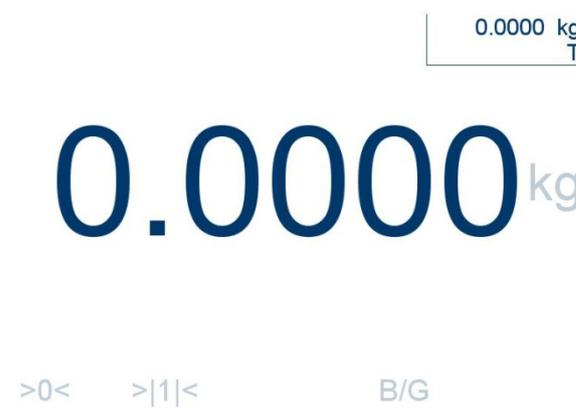
**Figura 3-45: Pantalla de tara cuando la pantalla auxiliar se define como Tara siempre**
