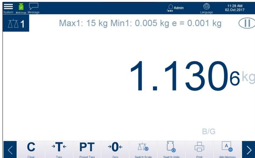
Figura 2-31: Pantalla de peso para la plataforma de pesaje IDNet clase II de calibración
