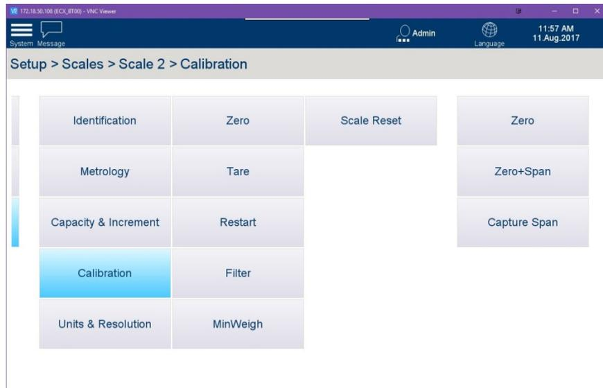
**Figura 3-23: Opciones de calibración de básculas, básculas que no son IDNet**
