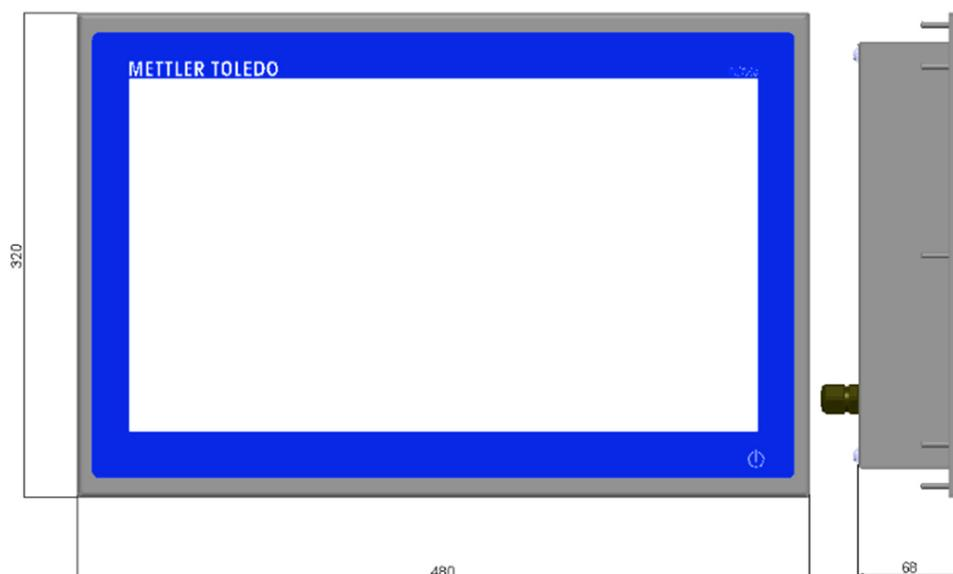
**Figura 1-6: Dimensiones de IND970-19, montaje en la pared**
